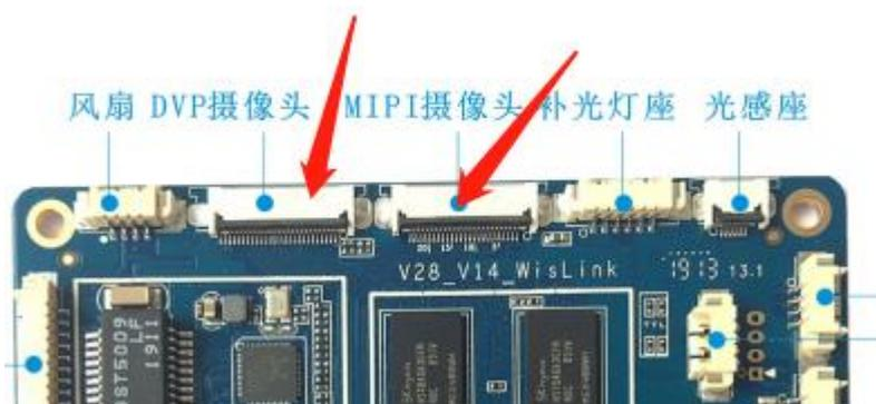
板卡最高支持 800w 像素的 mipi 摄像头，卡座的电气定义如下：
